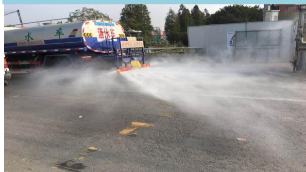
厂区道路降尘
